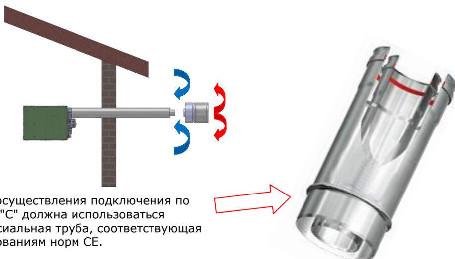
Для осуществления подключения по типу "С" должна использоваться коаксиальная труба, соответствующая требованиям норм CE.
