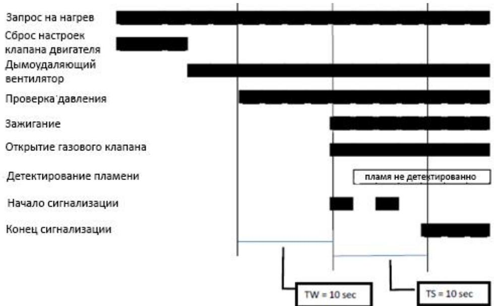
Удостоверившись в том, что теплогенератор заблокировался, в соответствии с диаграммой, откройте газовый кран, разблокируйте теплогенератор путем отключения и повторного включения электропитания. Затем, проверьте правильность его запуска в соответствии с функциональной диаграммой ниже.
